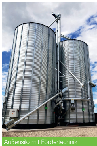
Kettenelevator mit Getreidekanone
