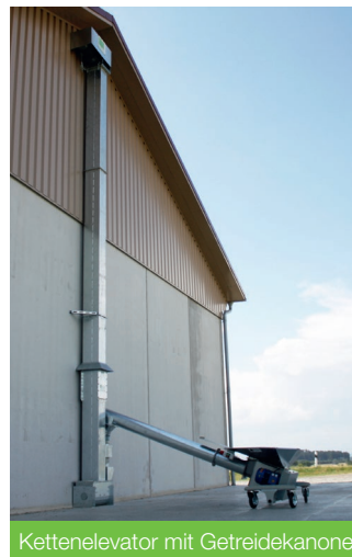
GFK-Silos mit Kettenelevator
