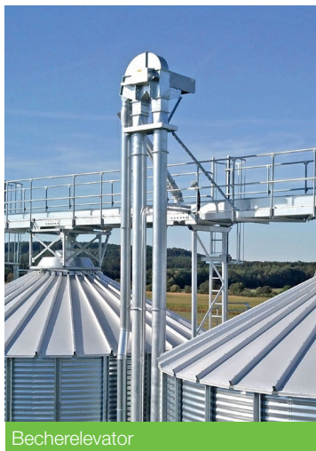
Außensilo mit Fördertechnik
