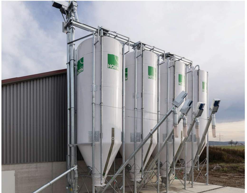
GFK Silos mit Siloentnahmeschnecke
