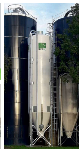
GFK Silo 75 cbm
